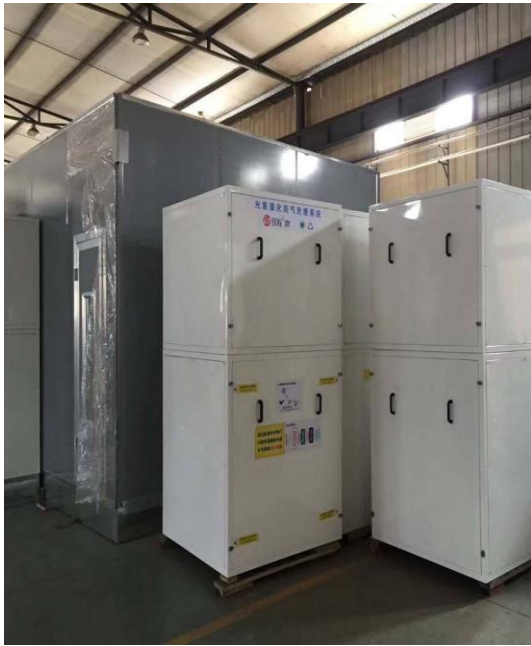
喷烤漆房废气处理装置
